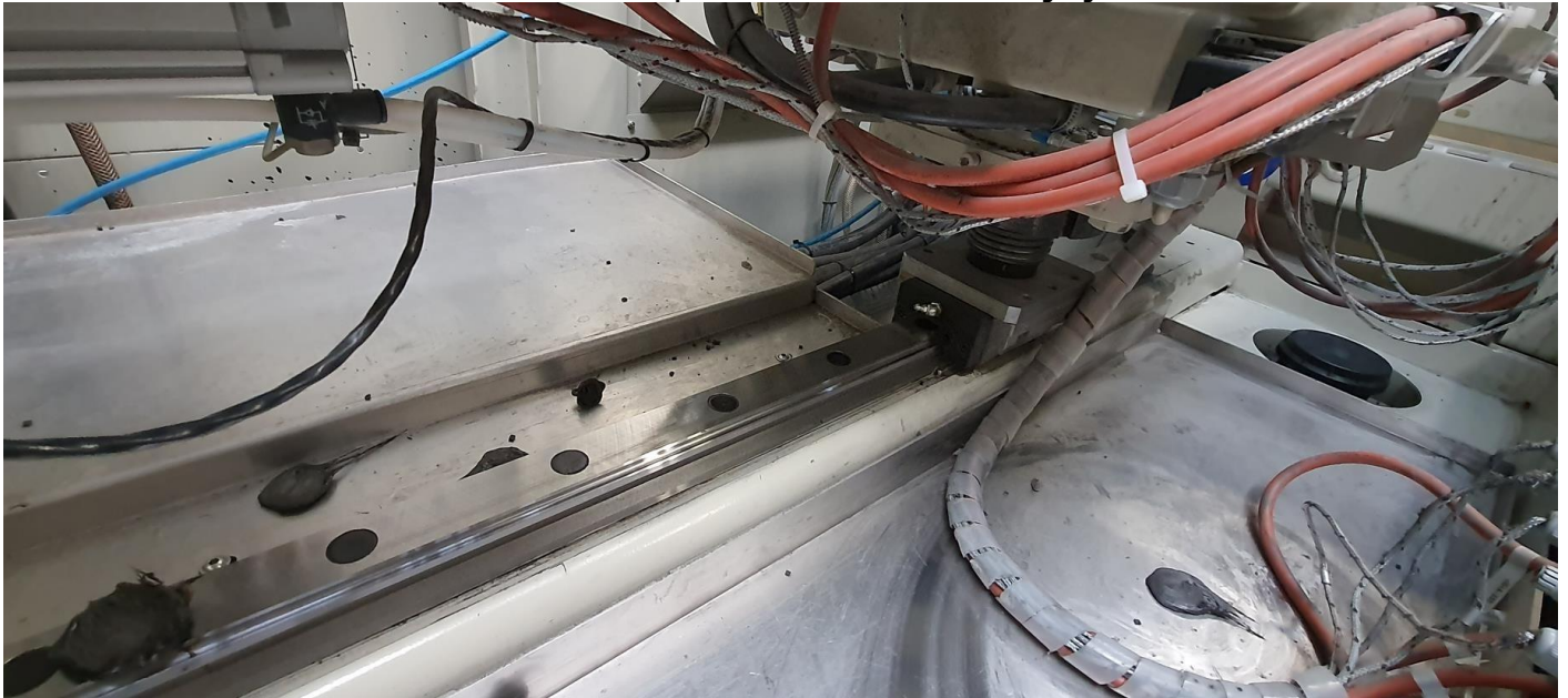
Guia linear apoio do cilindro de injeção:
